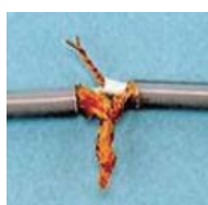
同軸ケーブルの 手ひねり接続
